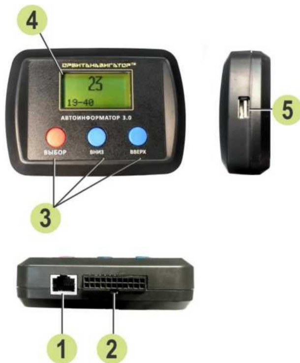
Рис. 1 . Элементы управления и индикации Автоинформатора. 1 — разъем микрофона (тангенты); 2 — основной 22-контактный интерфейсный разъем с питанием; 3 — кнопки ВЫБОР, ВНИЗ, ВВЕРХ; 4 - текстовый ЖК дисплей; 5 - USB разъем.
